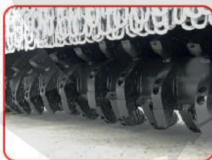
Martillos fijos de acero especial
